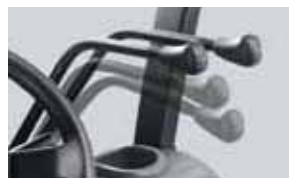
Рычаги рассчитаны на управление кончиками пальцев.
