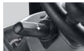
Электрический рычаг переключения переднего/заднего хода (модель с коробкой передач "ТОРКФЛОУ" [TORQFLOW])
