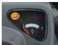
Контрольная лампа блокировки подъемника на панели приборов
